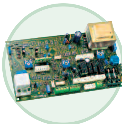
Scheda elettronica con microprocessore.
